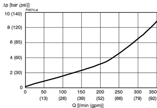
$\Delta p = f(Q)$  Druckverlust-Volumenstrom-Kennlinie
